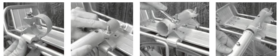
Démontez le support et montez les attaches de chaque côté du porte-bagages.
