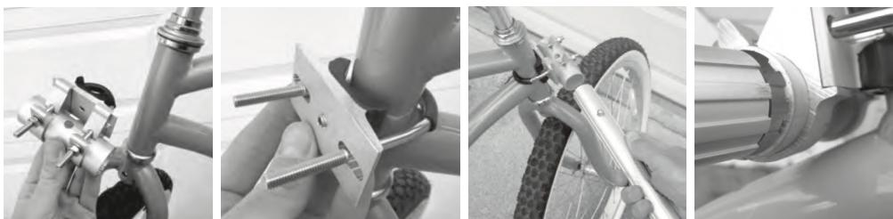
Montez le support avant sur l'avant du cadre, sans gêner aucunement le guidon!
