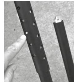
Assemblez les deux bras tel que sur la photo 1, il y a 5 positions de réglages possibles.
